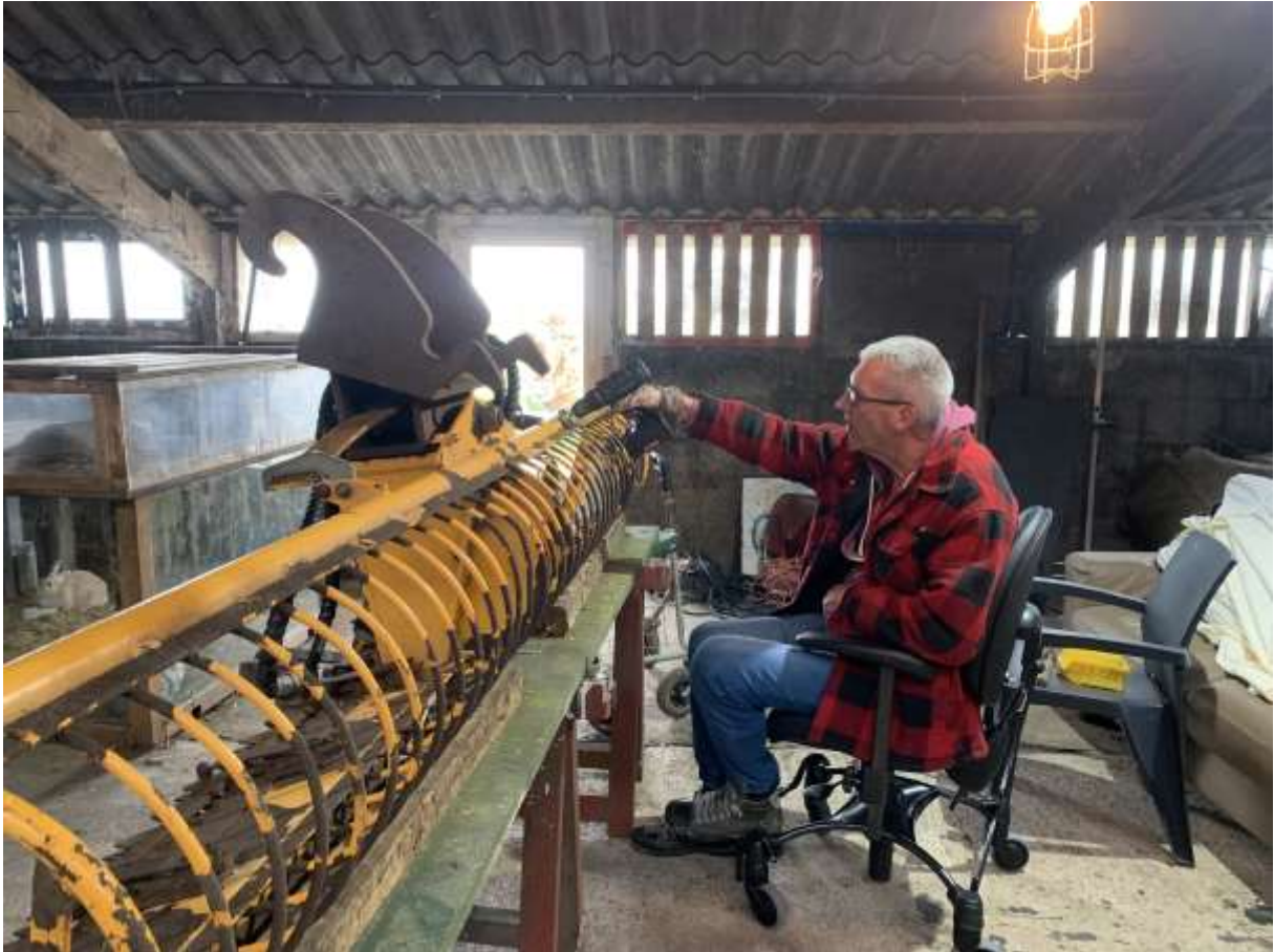
Frank is alweer aan een nieuwe klus; het opknappen van de maaikorf. Daarmee wordt het riet uit de sloten gehaald om te voorkomen dat de sloot dichtgroeit.
